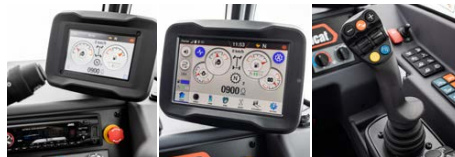
5" displej s Bluetooth rádiem, mikrofonem a reproduktory 7" dotykový displej (vestavěné Bluetooth rádio s mikrofonem, ovládání telefonu a pracovní nastavení) Smart joystick s plovoucí polohou ramene a oklepem lopaty
