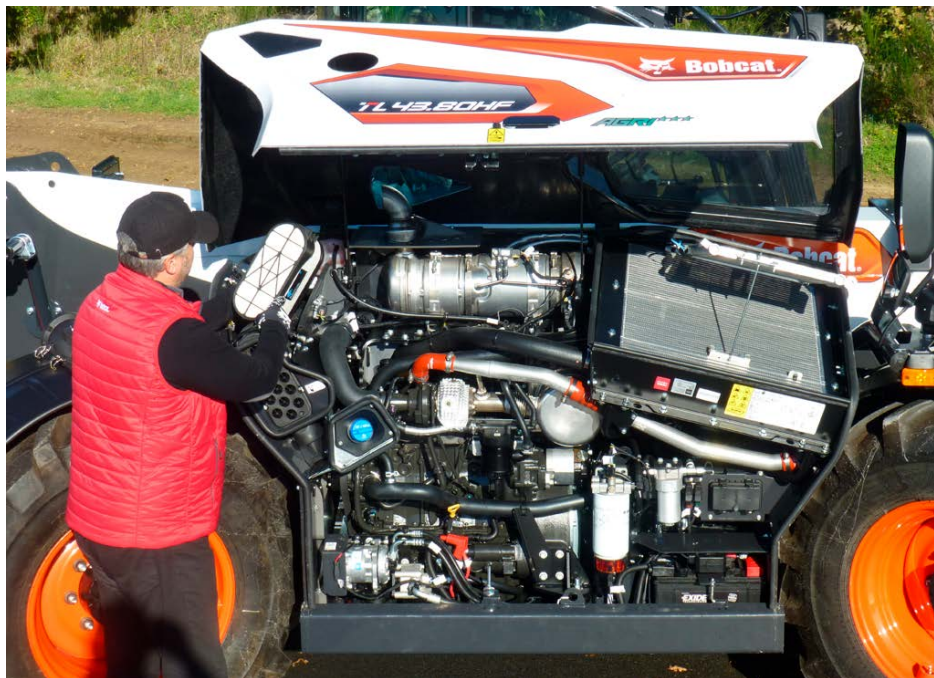
Jednoduchý přístup ke všem servisním místům v motorovém prostoru
